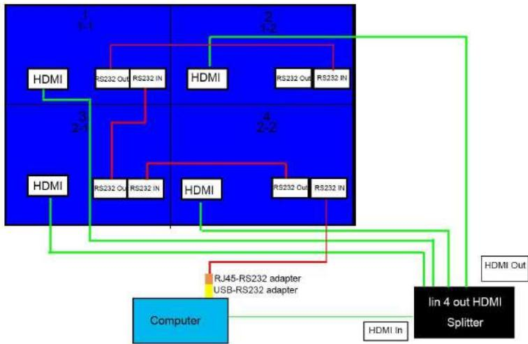
1. Подключение сплиттера MWS
