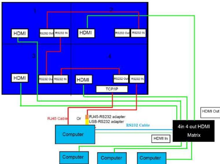
2. Подключение матричного контроллера MWMX
